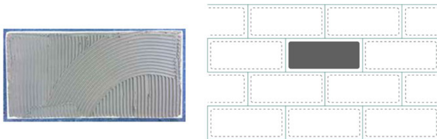
Fig. 20: Esquema de aplicación de fijación mediante llana dentada
