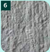
Granallado medio/ profundo o fresado ligero
