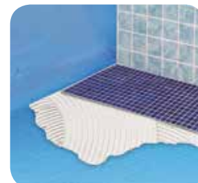
7 Colocación baldosas cerámicas.
